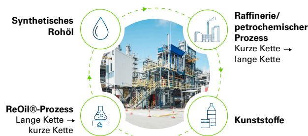
Im Jahr 2019 arbeitete die OMV an der Definition der erforderlichen technischen Parameter für eine weitere Skalierung und initiierte den Engineering-Prozess zur Entwicklung einer ReOil®-Demonstrationsanlage mit einer Altkunststoffkapazität von 16.000 bis 20.000 t pro Jahr.
