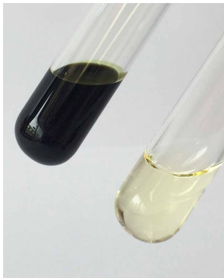
Algenölextrakt (unbehandelt) und Algenölextrakt (mit Wasserstoff behandelt)
